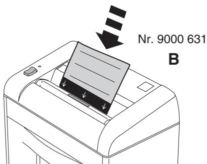
**DE** Bei nachlassender Schneidleistung oder nach jedem gefüllten Auffangsack Schneidwerk ölen! (siehe Bild)
