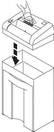
**DE** Maschine in den Auffangbehälter bzw. Unterschrank setzen.
